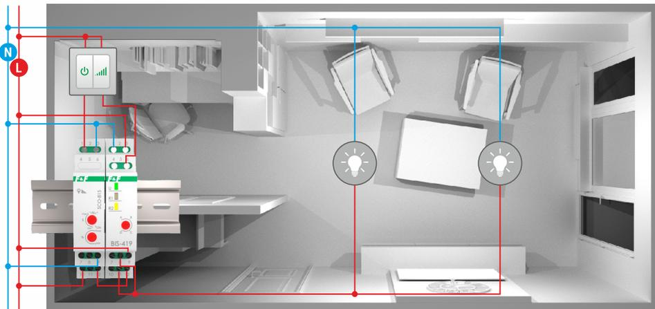
Нажатие первой клавиши выключателя включает освещение с установленным посредством диммера SCO-815 уровнем яркости, второе нажатие этой же клавиши с интервалом не более 5 секунд включит освещение на полную мощность. Нажатие и удержание второй клавиши регулирует яркость освещения.
